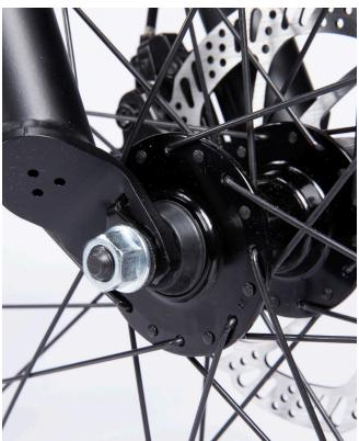
• ENSURE THE WHEEL IS FULLY INSERTED. USE A 15MM WRENCH TORQUE THE AXLE NUTS TO 45 NM
