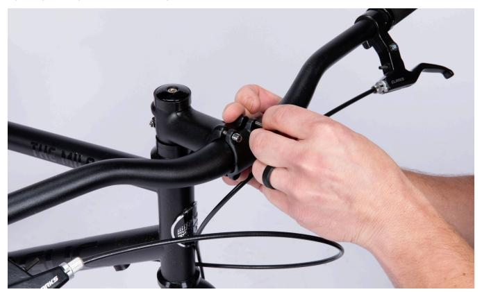
\*NOTE: MAKE SURE THE HANDLEBARS ARE ROTATED SO THE BRAKE LEVERS ARE AT A COMFORTABLE ANGLE WHEN GRIPPED. WHILE IN THE RIDING POSITION, YOUR WRIST SHOULD BE STRAIGHT AND AT A NATURAL COMFORTABLE ANGLE WHEN PULLING THE BRAKE LEVERS.
