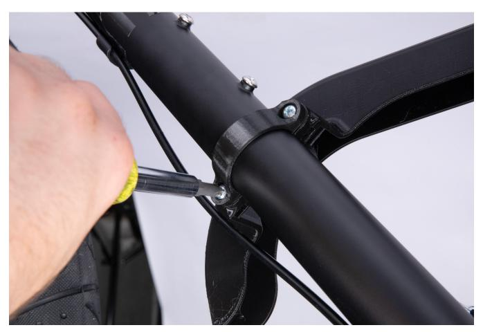
• CLAMP THE REAR HALF OF THE BELT GUARD TO THE DRIVE SIDE SEAT STAY TUBE AS SHOWN BELOW
