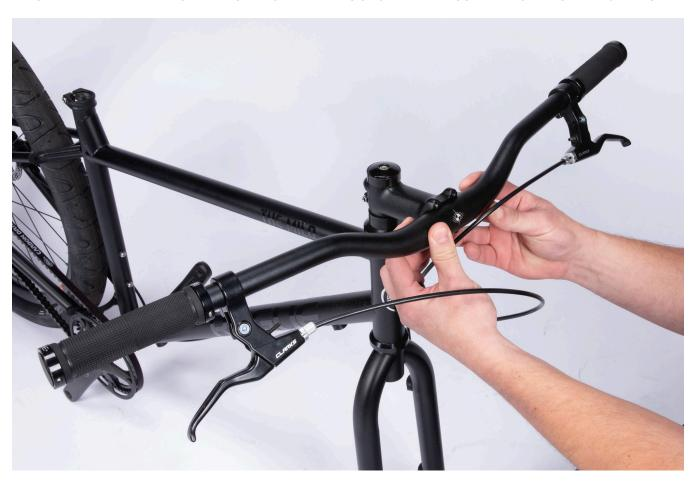
• TIGHTEN THE 4 BOLTS STEM FACE HAND TIGHT EVENLY SO THE GAP ABOVE THE HANDLEBARS IS THE SAME. AS THE GAP BELOW THE HANDLEBARS
